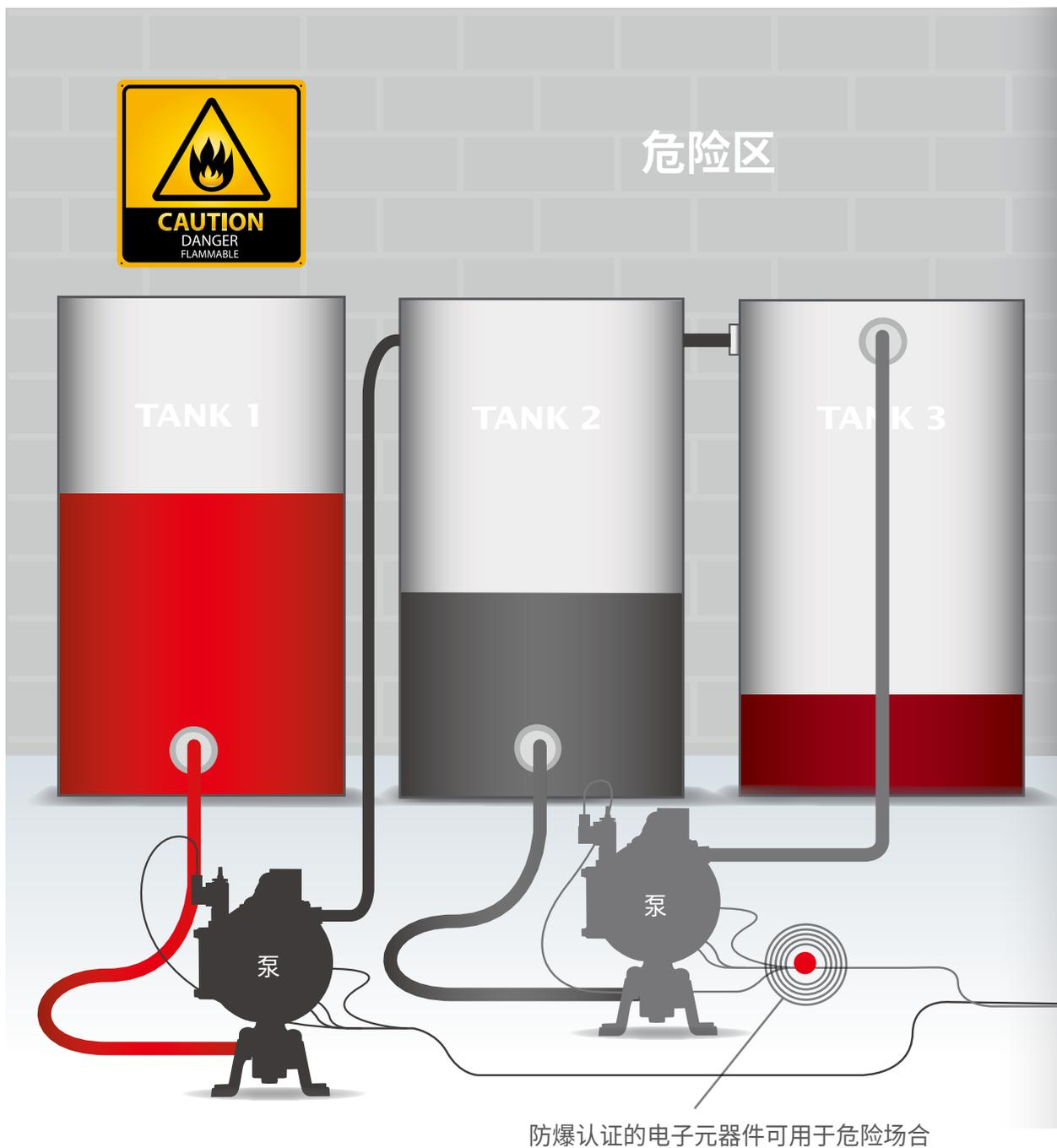
ARO EXP电子接口泵常用于输送各类溶液、乙醇、液体燃料及其他易燃易爆的高危物料,包括化学品流程输送、能源原料及废料的输送应用。
